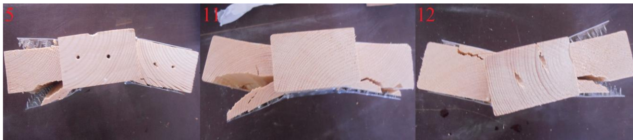
49 pav. 90 dienų kambario temperatūroje laikytų bandinių (5, 11 ir 12) vaizdas iš viršaus po gniuždymo bandymo
