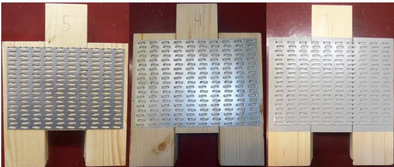
32 pav. Bandiniai padengti skirtingomis antikorozinėmis priemonėmis
