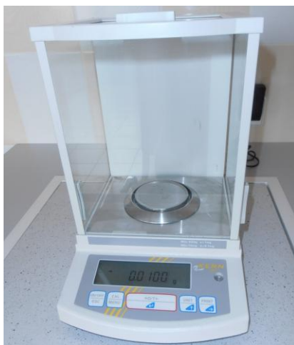
66 pav. „KERN ABJ 220-4M“ analitinės svarstyklės
