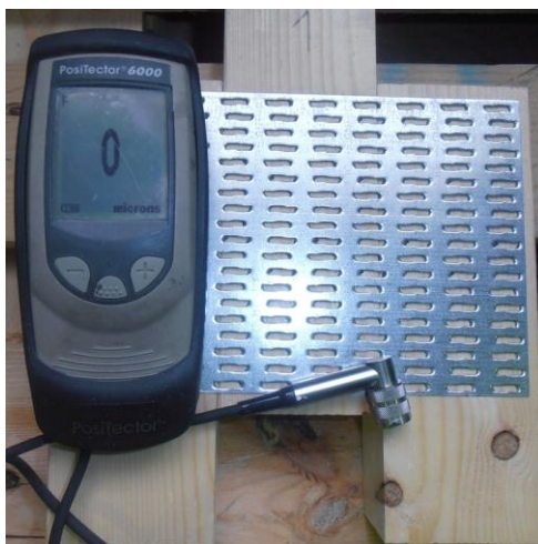
33 pav. Dangos storio matavimo prietaisas „PosiTector 6000“
