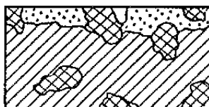
4 pav. Selektivoji ištinė korozija
