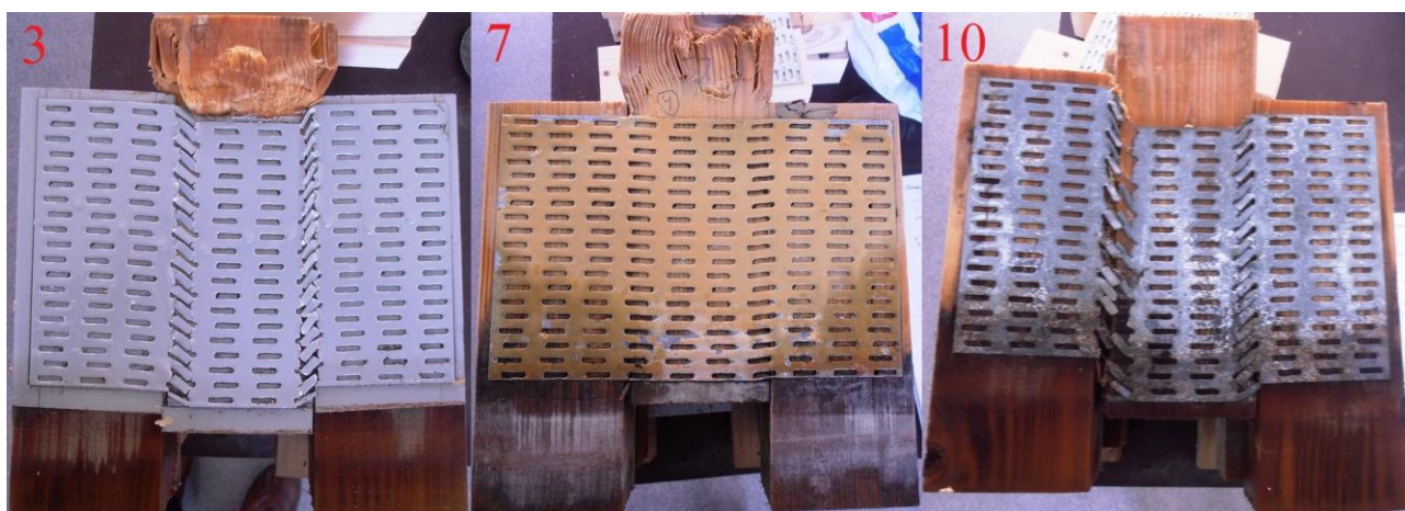
46 pav. Drėgni bandiniai (3, 7 ir 10) po gniuždymo bandymo
