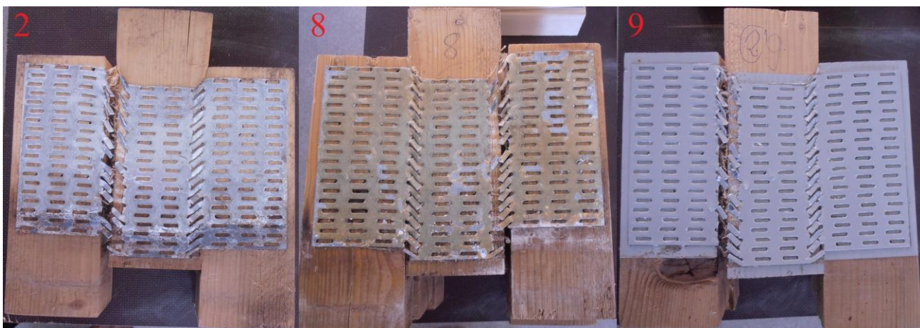
47 pav. 7 dienas džiovinti bandiniai (2, 8 ir 9) po gniuždymo bandymo
