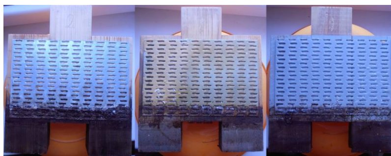
36 pav. Bandiniai po 90 dienų išlaikymo agresyvioje aplinkoje
