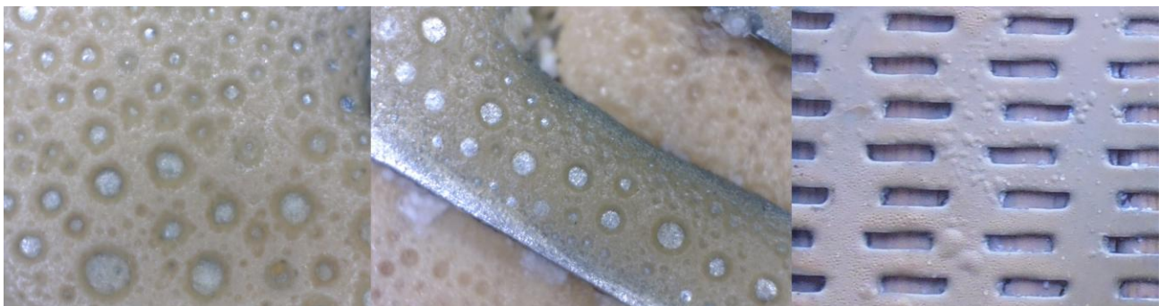
41 pav. Apsauginės dangos „DINITROL 4010“ pažeidimai
