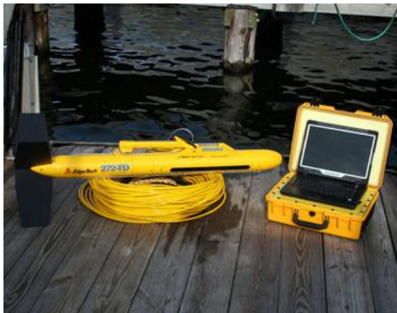
54 pav. Šoninės apžvalgos sonaro sistema Edgetech 4100 (BPATPI duomenų fondai)
