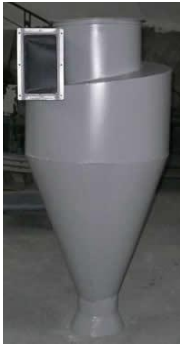
1.9 pav. ЦП–2 tipo ciklonas (Промышленные вентиляторы 2012)
