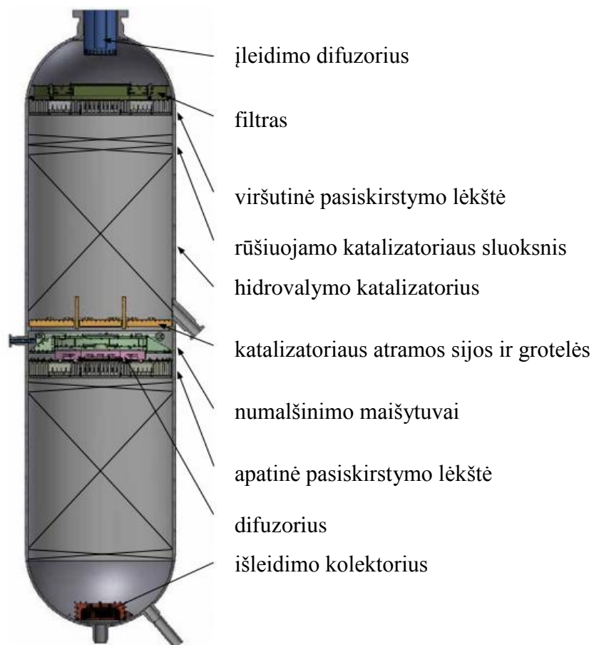
9 pav. „Haldor Topsoe“ hidrovalymo reaktoriaus skerspjūvis
