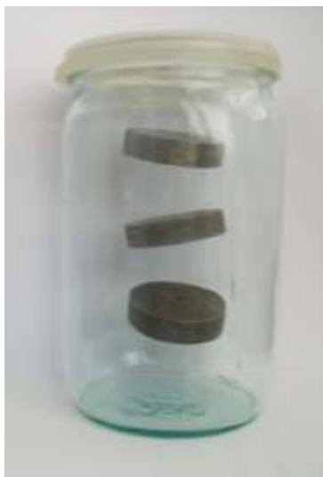
24 pav. Korozijos bandymams paruošti mėginiai
