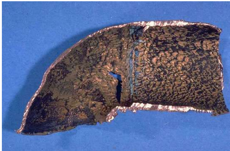
3 pav. Erozinė korozija
