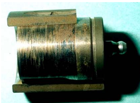
6 pav. Trinties korozija
