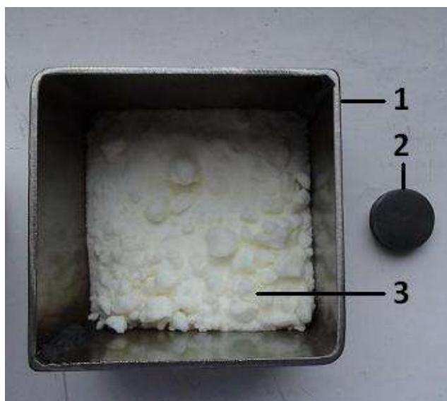
17 pav. Druskos vonelė: 1 – metalinė vonelė, 2 – bandinys, - 3 – Natrio nitrato ( \text{NaNO}_3 ) druska
