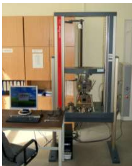
21 pav. Zwick/Roell Z100 bandymo mašina
