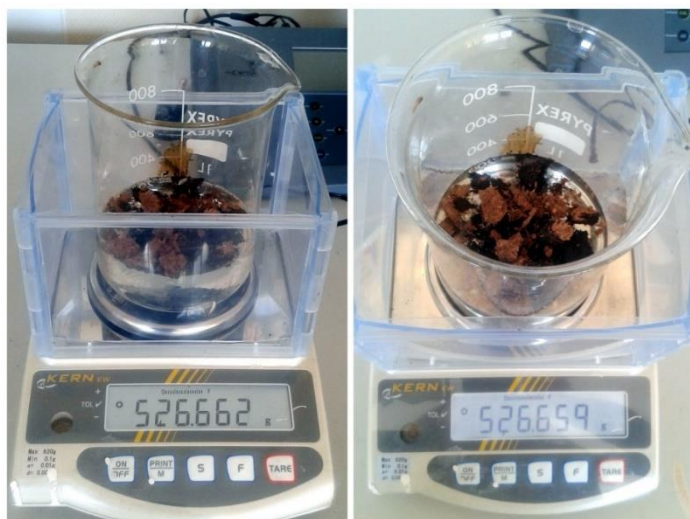
20 pav. Vandens paviršiuje išlietos žaliavinės naftos/dyzelino nugaravusio kiekio tyrimo stendas
