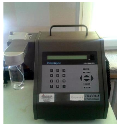
13 pav. Žaliavinės naftos ir dyzelino kokybės rodiklių nustatymui naudoti prietaisai:
