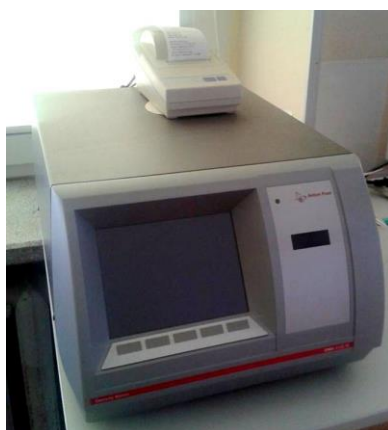
13 pav. Žaliavinės naftos ir dyzelino kokybės rodiklių nustatymui naudoti prietaisai:
