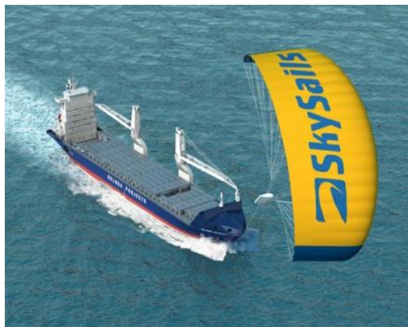
3 pav. Jėgos aitvarų naudojimas taupant kurą
