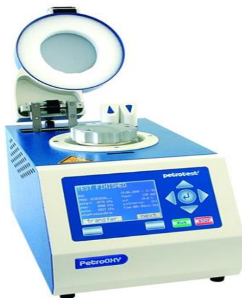
17 pav. Automatinis oksidacinio stabilumo analizatorius „Petro OXY“
