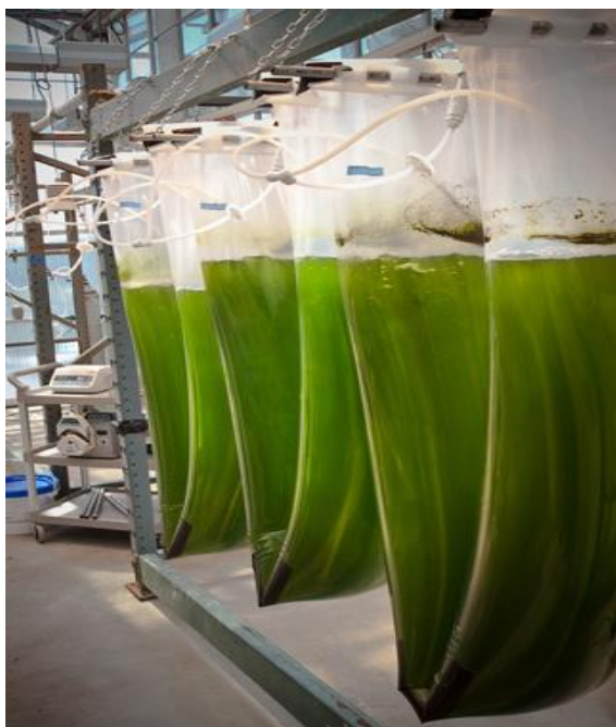
3 pav. Vertikalus vamzdinis reaktorius (Ugwu, 2008)
