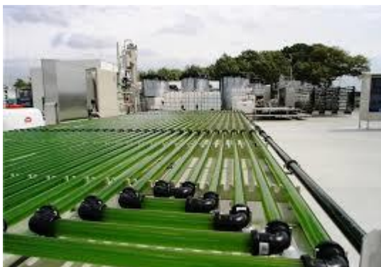
4 pav. Horizontalus vamzdinis reaktorius (Carvalho, 2006)
