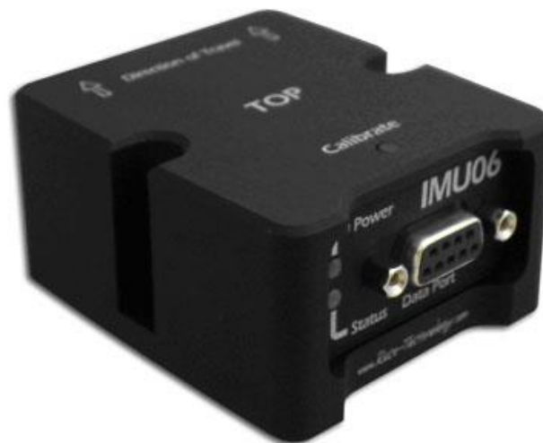
3.2 pav. „IMU-06“ jutiklis (Race technology 2014)
