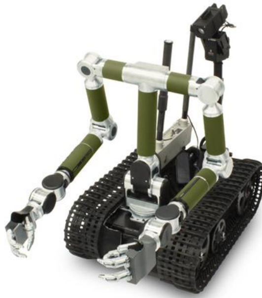
1.9 pav. „HDT MK2“ manipulatorius (MK2 robotic... 2012)
