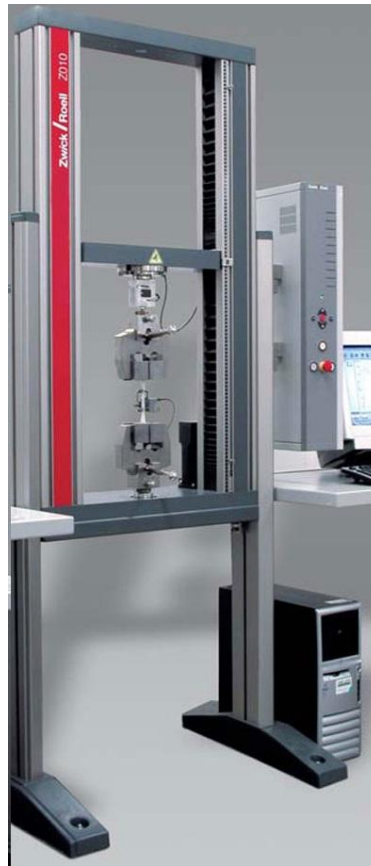
28 pav. Universalios mechaninės tempimo mašinos Zwick/Roel Z100 vaizdas
