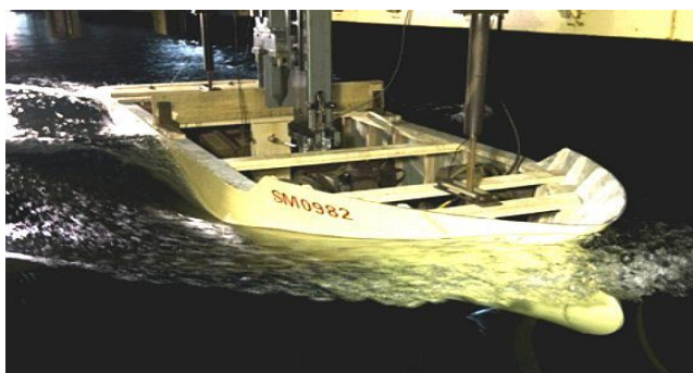
10 pav. Laivo modelio eigumo bandymas baseine.
