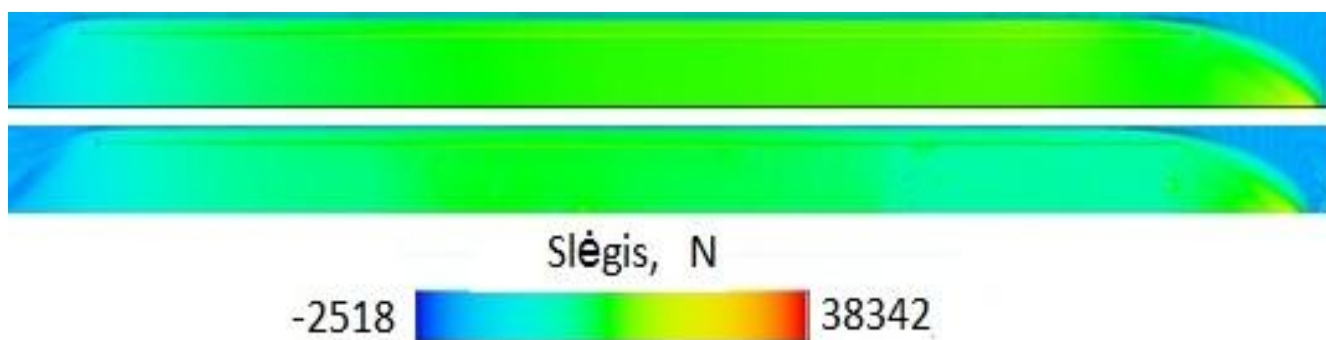
3.4.5 pav. Vandens slėgio pasiskirstymas po laivo korpuso dugnine dalimi esant laivo greičiui 3,5 m/s ir tiekiant orą po laivo korpusu.
