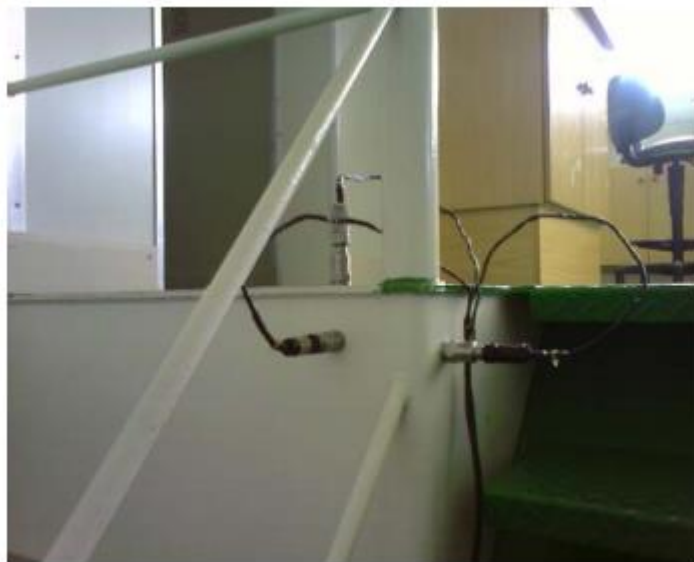
1.4.5 pav. Virpesių matavimas vairinėje
