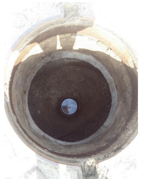
8 pav. Giluminis reperis (UAB „Inžineriniai tyrinėjimai. <...>“ 2007 (kairėje); fotografuota autoriaus 2016 (dešinėje))
