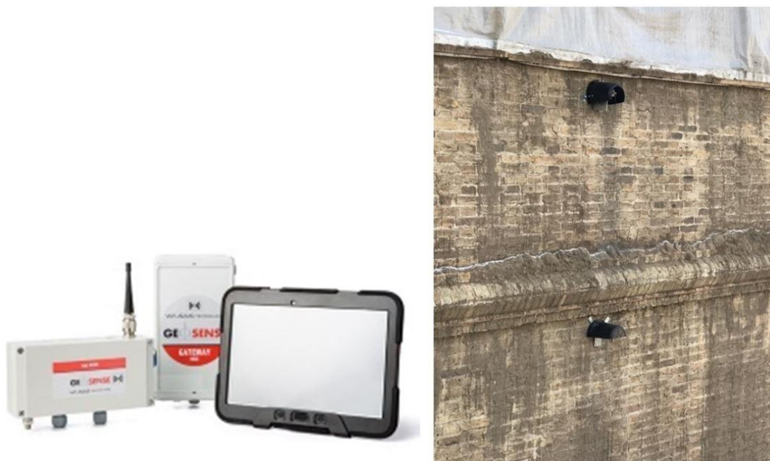
26 pav. Kairėje – GEOSENSE komutatorius, posvyrio sensorius ir lauko valdiklis; dešinėje – įmontuoti posvyrio sensoriai T4 ir T5 (Abromavičius 2017)
