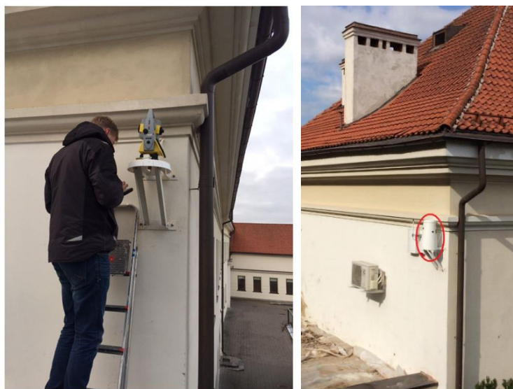
23 pav. Kairėje – elektroninio tacheometro montavimas (Abromavičius 2017); dešinėje – įmontuotas elektroninis tacheometras (fotografuota autoriaus 2017)
