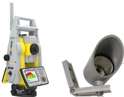
22 pav. Kairėje – elektroninis tacheometras GEOMAX Zoom 90S; dešinėje – monitoringo prizmė su apsauginiu stogeliu (Abromavičius 2017)
