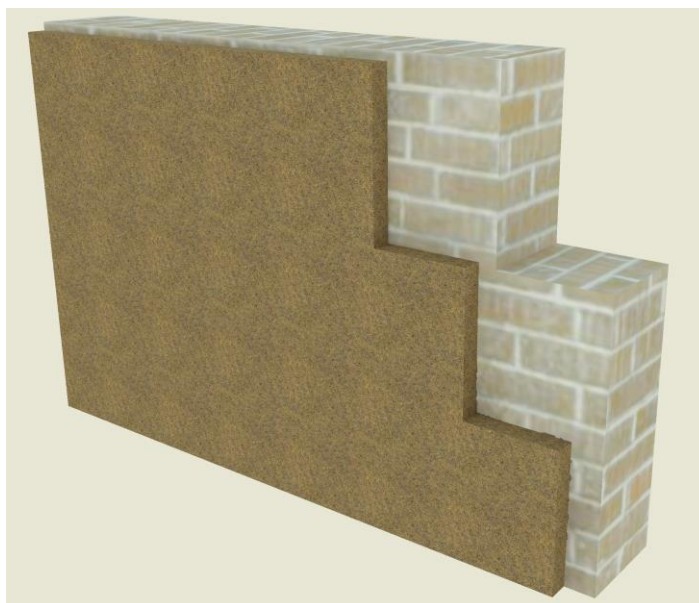
9 pav. Steico Special - medžio plaušo plokštės įrengimas
