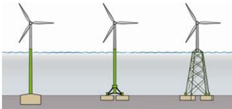
12 pav. Kesoninių pamatų tipai (iš kairės į dešinę: monopodinis, tripodinis ir tetrapodinis) (Houlsby et al., 2005)
