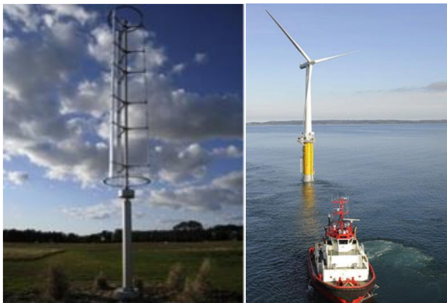
4 pav. Vertikalios ašies (kairėje) ir horizontalios ašies (dešinėje) vėjo jėgainės (Kaiser et al., 2012; Zanforlin et al., 2016)
