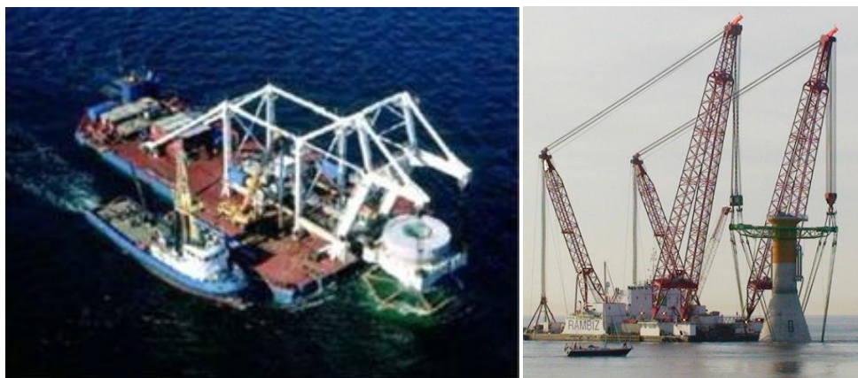
10 pav. Gravitaciniams pamatams montuoti naudojama įranga (Esteban et al., 2015; Kaiser et al., 2012)
