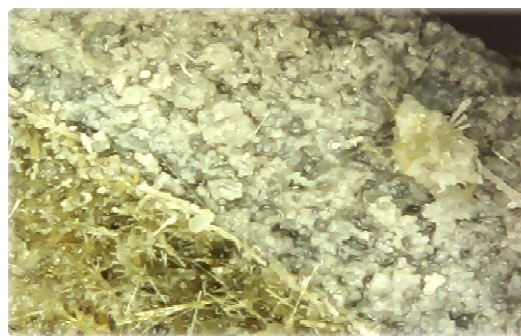
17 pav. Bandiniai su baigiamuoju klijų sluoksniu: sausi (kairėje) ir įmirkę (dešinėje). Vaizdas padidintas 15 kartų.
