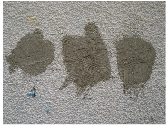
25 pav. Smūginių įspaudų vietos, užbertos cemento milteliais ir užlygintos glaistykje.
