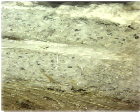
18 pav. Bandiniai su baigiamuoju dekoratyvinio tinko sluoksniu: sausi (kairėje) ir įmirkę (dešinėje). Vaizdas padidintas 15 kartų.
