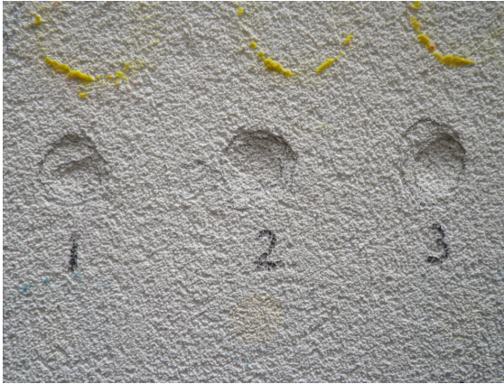
24 pav. Smūginiai įspaudai paviršiniame ETICS sluoksnyje (po standartizuotų bandymų).
