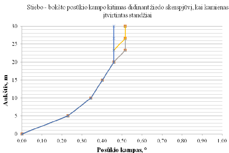
2.21 pav. Kilnojamojo stiebo – bokšto viršūnės posūkio kampo diagrama, kai kamienas įtvirtintas standžiai
