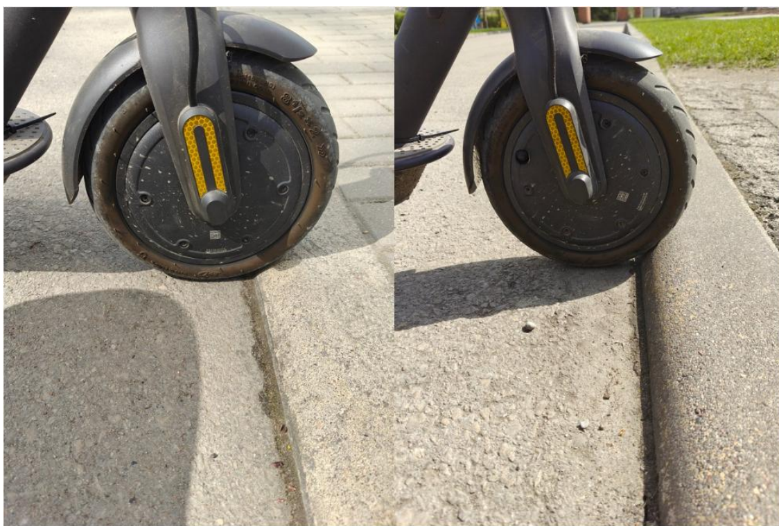
21 pav. Elektrinio paspirtuko kliūtys: a) 22 mm aukščio kliūtis, b) 35 mm aukščio kliūtis
