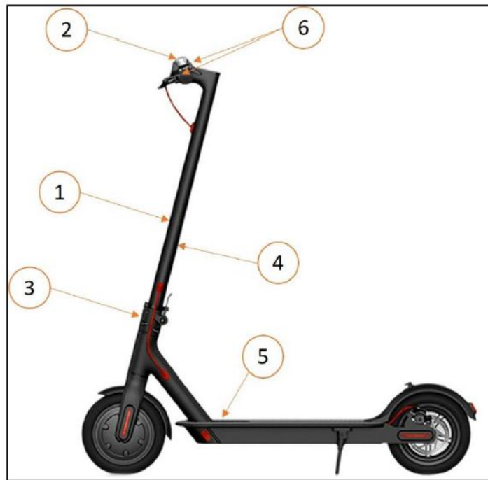
1 pav. Paspirtuko jutiklių išdėstymas ant tiriamo paspirtuko. 1 – įtempimų jutiklis vairo apkrovai matuoti; 2 – kamera kelio stebėjimui; 3 – potenciometras vairo susukimui matuoti; 4 – vaizdo kamera fiksuojanti paspirtukininko padėtį; 5 – duomenų kaupiklis su GPS imtuvu; 6 – akceleratoriaus ir stabdžių svirties jutikliai (Garman et al., 2020)
