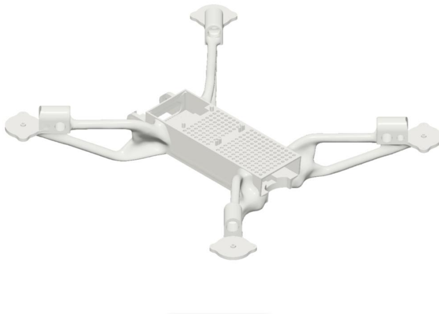
34 pav. Sugeneruotas drono korpusas su generatyvinio dizaino algoritmais
