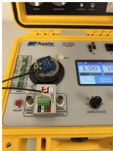
6 pav. Vibracijos jutiklio kalibravimo stendas [17]
