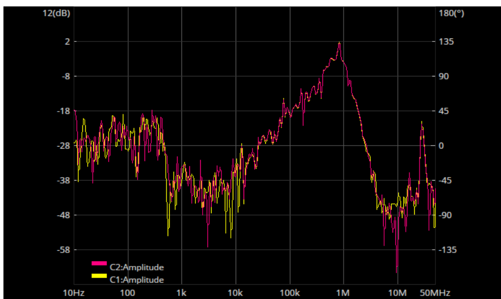
44 pav. Žemo dažnio filtro CMRR svorio jutiklio matavimo spausdintinėje plokštėje
