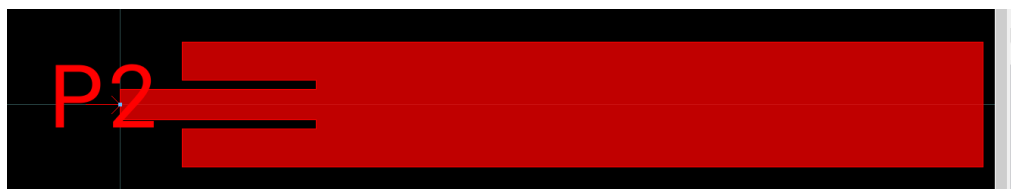
2.27 pav. Vientisos PA 2200 antenos topologija (ADS Keysight).
