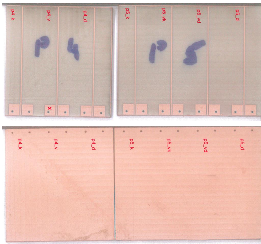
2.54 pav. Ant PEEK medžiagos pagaminti elektrodai.
