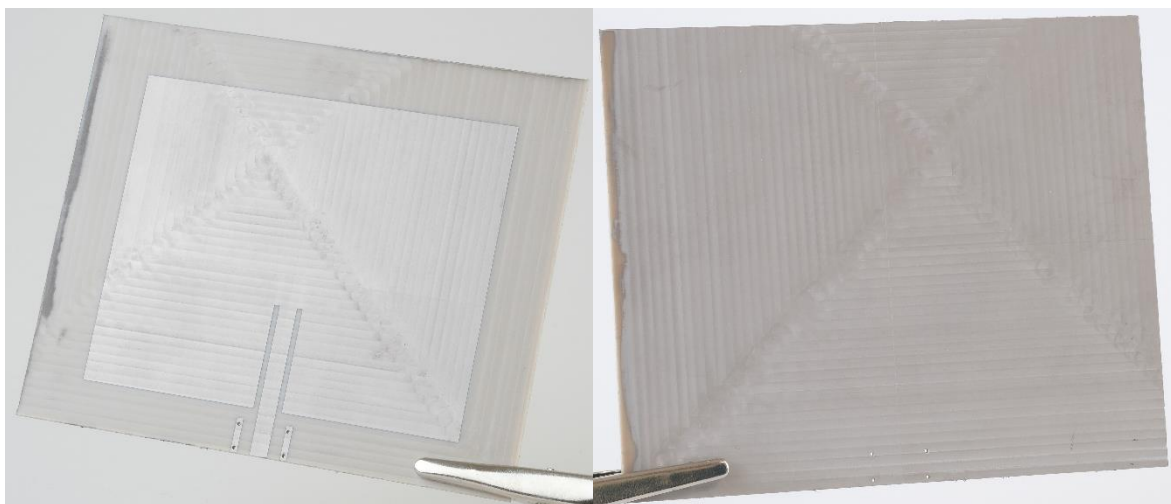
2.79 pav. SSAIL technologija pagaminta PEEK antenos: viršutinis sluoksnis (kairė), apatinis sluoksnis (dešinė).
