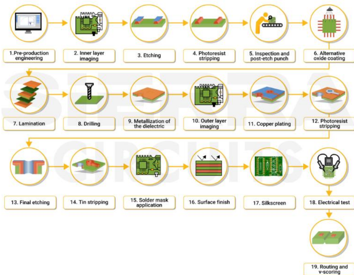
1.5 pav. Standartinių PCB gamybos proceso eiga (PCB Manufacturing ..., 2025).
