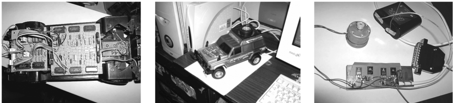
4 pav. Pavaros maketas, sukonstruotas studentų A. Moždžer, M. Narbuto ir kitų, iš žaislinės mašinėlės; čia a) – sumontuota valdymo elektronika, b) – prie kompiuterio prijungta šasi, c) – demonstruojamas tiriamasis mikrovariklis.
