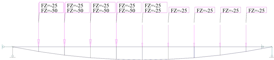
2.15 pav. Konstrukcijos apkrovimo schema, kai apkrovimas asimetrinis.
