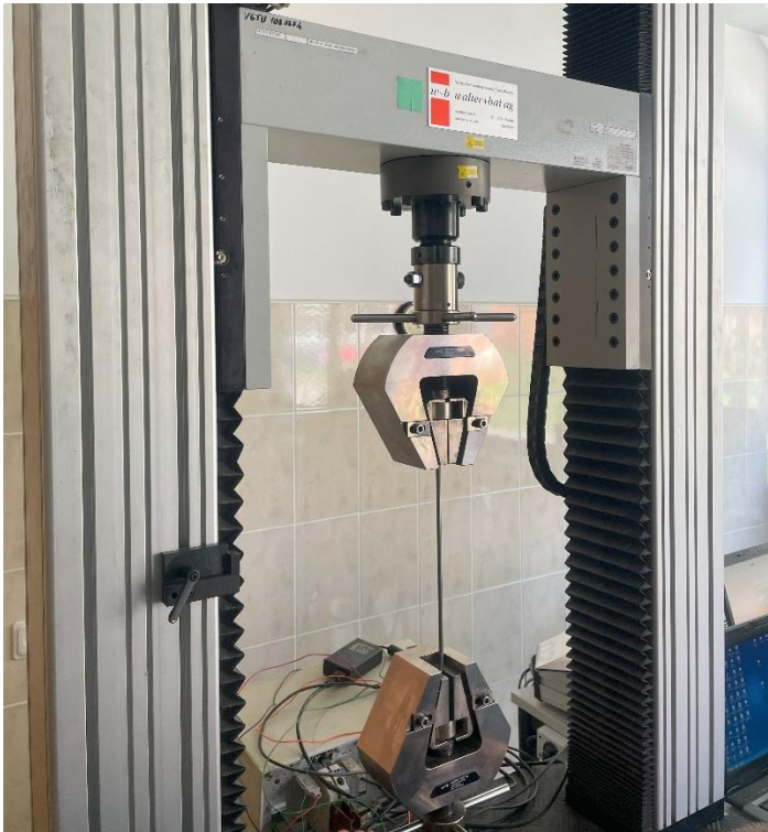
3.2 pav. Strypo tempimo bandymas Fig. 3.2. Rod tensile test
