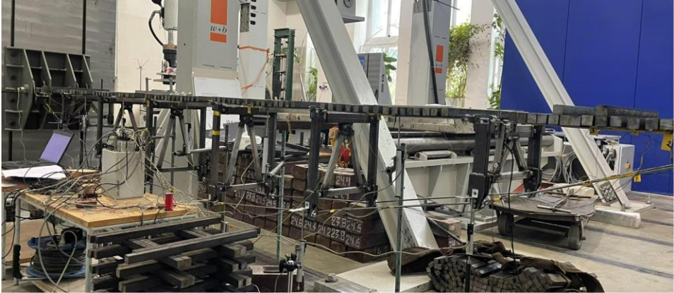
3.20 pav. Eksperimentinio modelio nuotrauka. Simetriškai apkrauta (nuolatinė apkrova) konstrukcija
