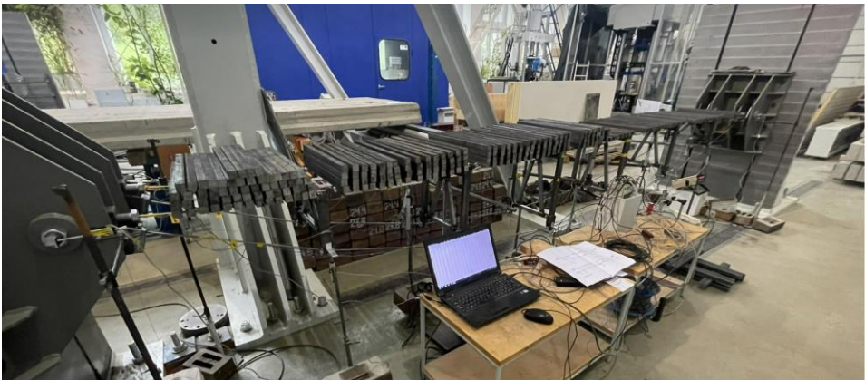
3.21 pav. Asimetriškai apkrauta modelio konstrukcija, kai veikia simetrinės nuolatinės ir kintamos (eismo) asimetrinės apkrovos
