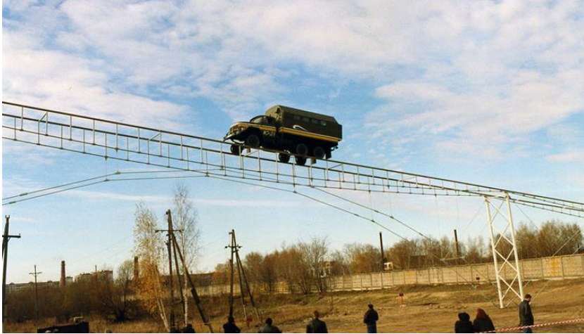
1.4 pav. Įtemptos styginės konstrukcijos bandymas (Unitsky, 2003) Fig. 1.4. The test of the tensioned string structure (Unitsky, 2003)
