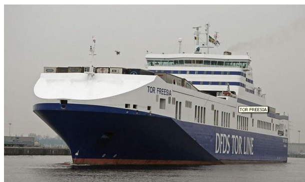
Fig. 2. Ro-ro vessel “Tor Freesia“, length 230 m, ship’s loading 4000 m
