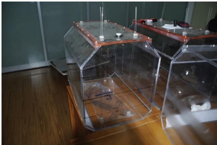
10 pav. Tankų modeliai, kurie buvo įdėti į laivo modelį [26].
