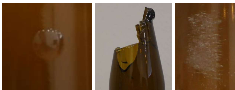
3.3 pav. Reprezentatyvios nuotraukos iš prižiūrimo mokymosi rinkinio, rodančios skirtingus defektų tipus
