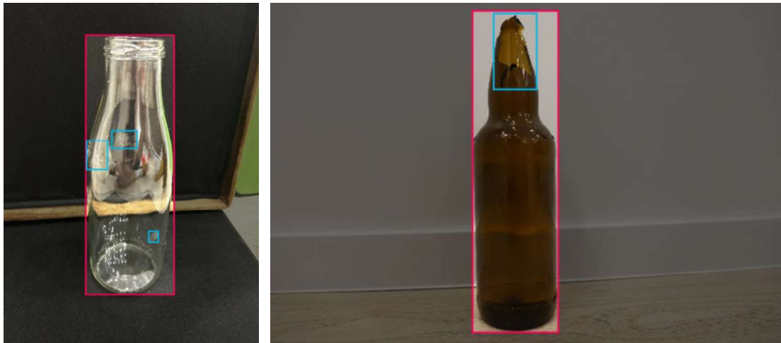
3.4 pav. Anotavimo pavyzdžiai: oro burbuliuko, įbrėžimo ir nudaužtos galvutės anotacijos RoboFlow aplinkoje
