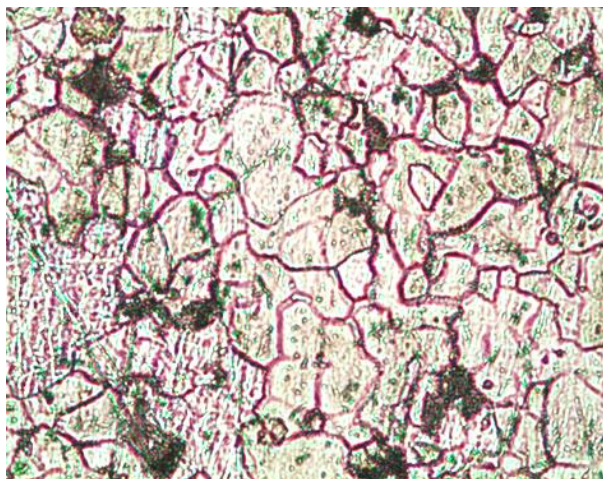
19 pav. Tiriamo plieno S235 bandinio paviršiaus mikrostruktūra (×200)
