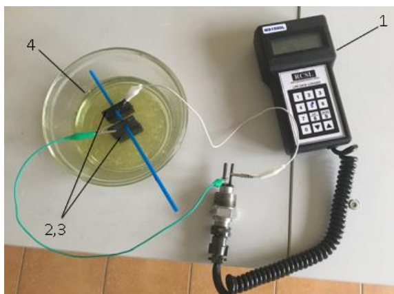
9 pav. Korozijos greičio matavimo schema: 1- prietaisas MS 1500L, 2,3 - tiriamo plieno bandiniai, 4- vonelė (indas) su korozine terpe
