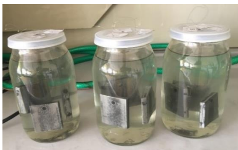
12 pav. S235 plieno bandiniai įmerkti į paruoštus indus su technologiniu kondensatu
