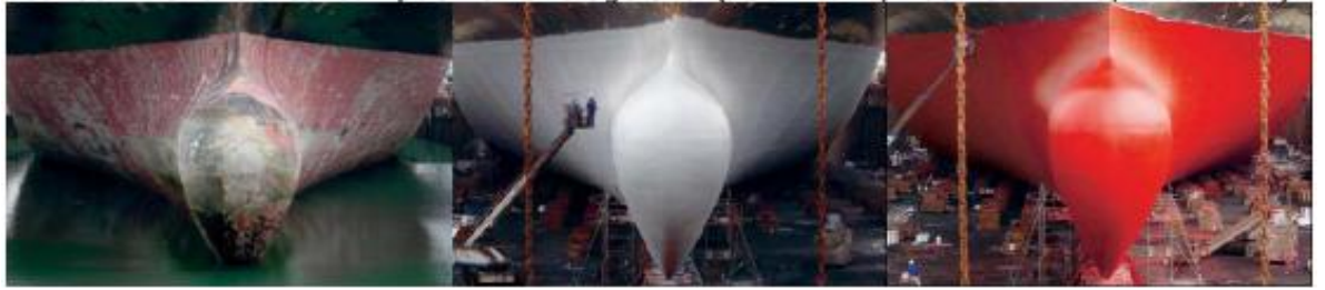
11. pav. Korpuso padengimas specialia danga „antifouling” Šaltinis: ICCT 2011, Voorham 2013, Crist 2009.
