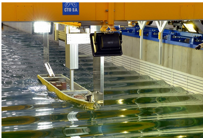
3 pav. Laivo modelio bandymų baseinas (Gdansk University of Technology, 2015)
