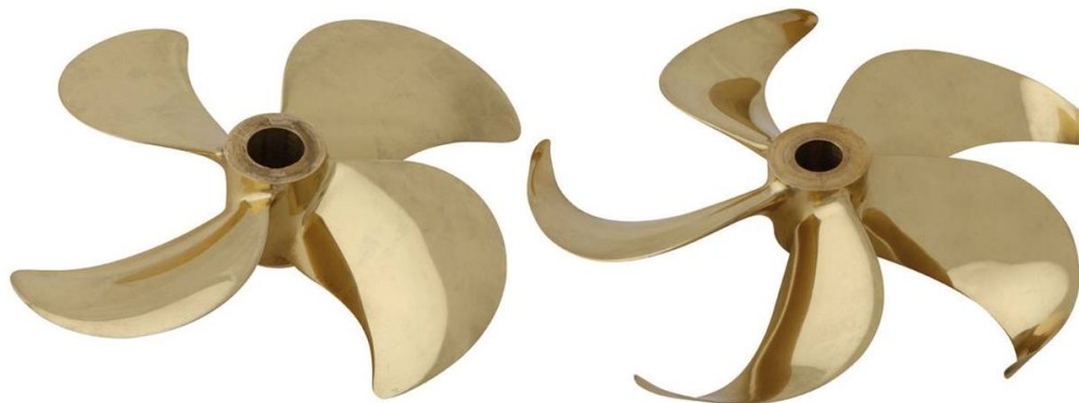
5 pav. Įprastas sraigtas ir Kappel tipo sraigtas
