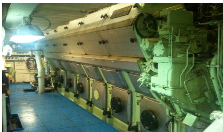
11 pav. WARTSILA 12V46 Pagrindinis variklis
