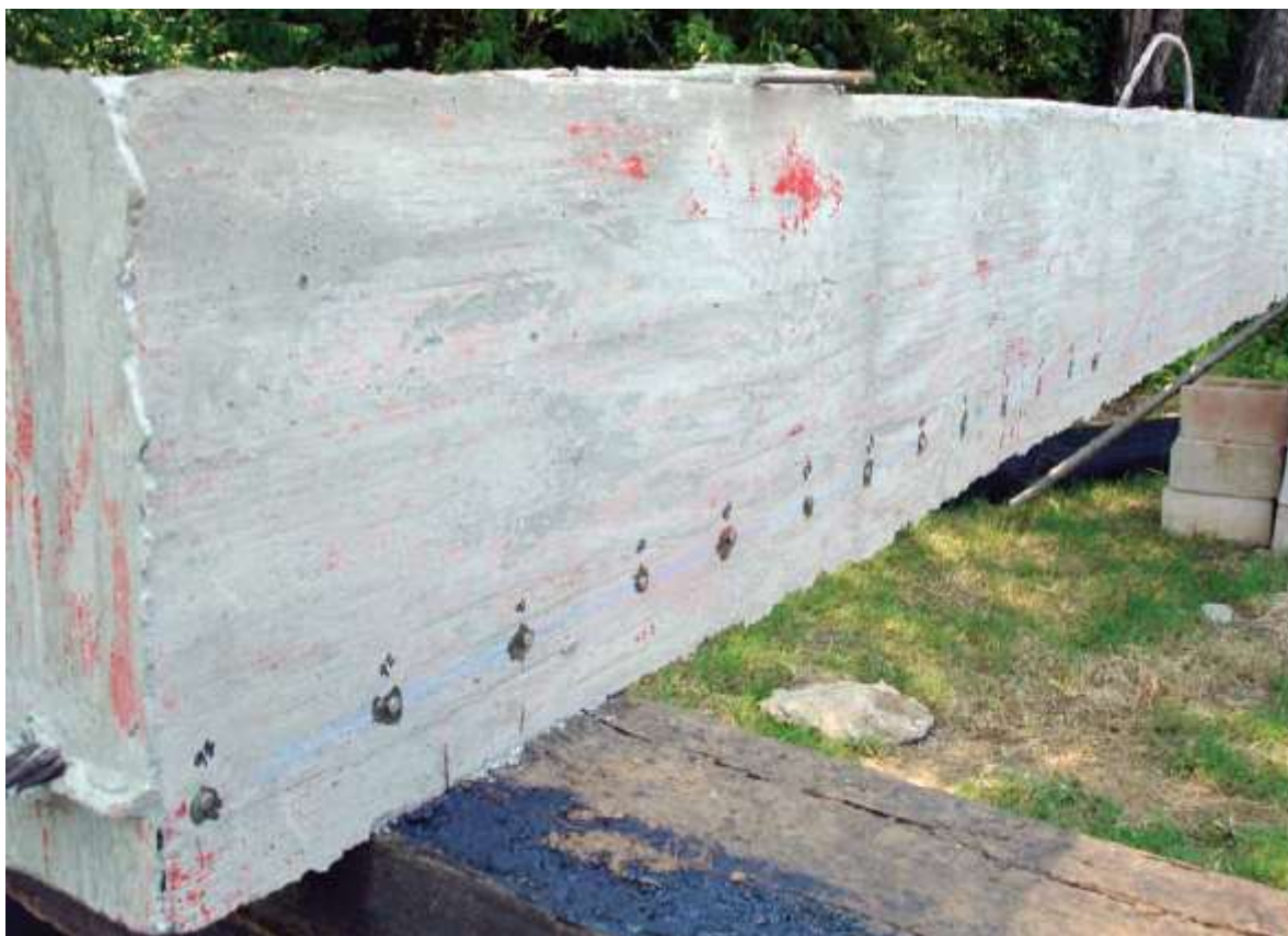
1.11 pav. Deformacijų matavimo taškai (Staton et al., 2009)
