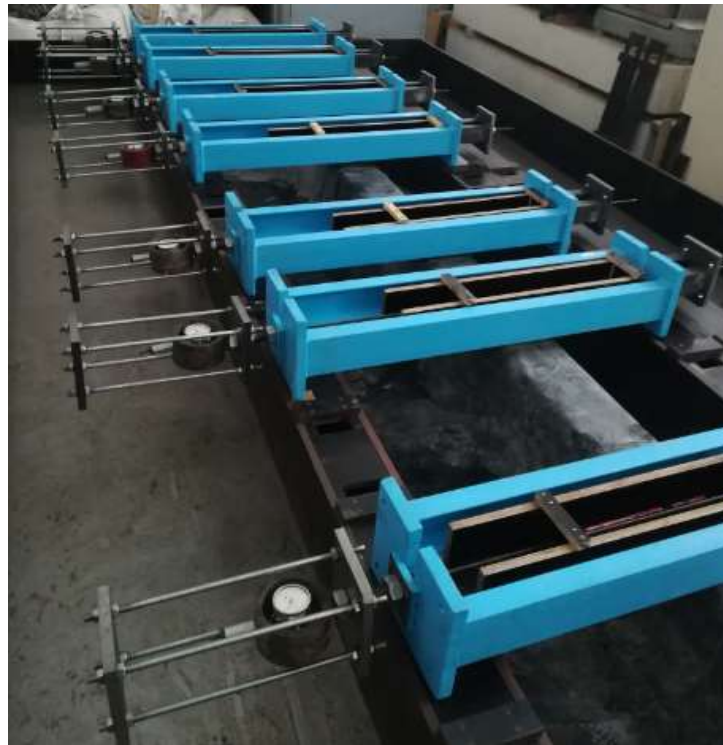
2.4 pav. Rėmai po įtempimo operacijos
