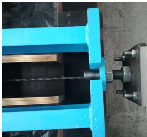
2.5 pav. Įtempimo fiksavimas: a) vaizdas bendroje schemoje ir b) padidintas vaizdas
