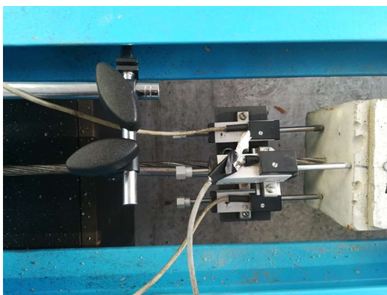
2.7 pav. Slinkties matavimo jutikliai: a) vaizdas bendroje schemoje ir b) padidintas vaizdas
