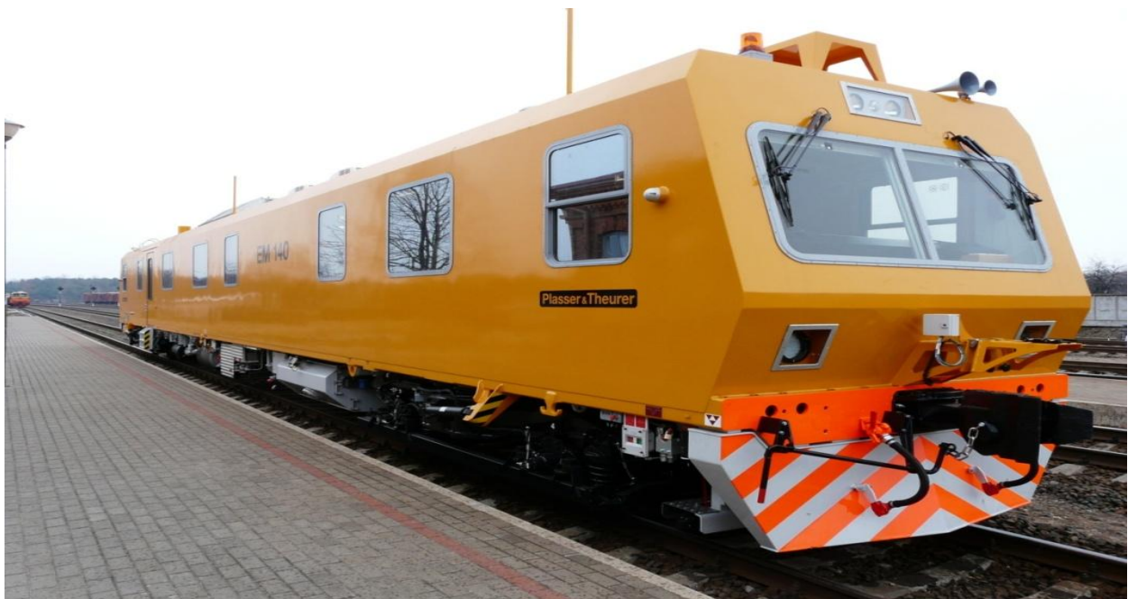
3.2 pav. Geležinkelio kelio kontrolės laboratorija (kelmatis EM-140)
