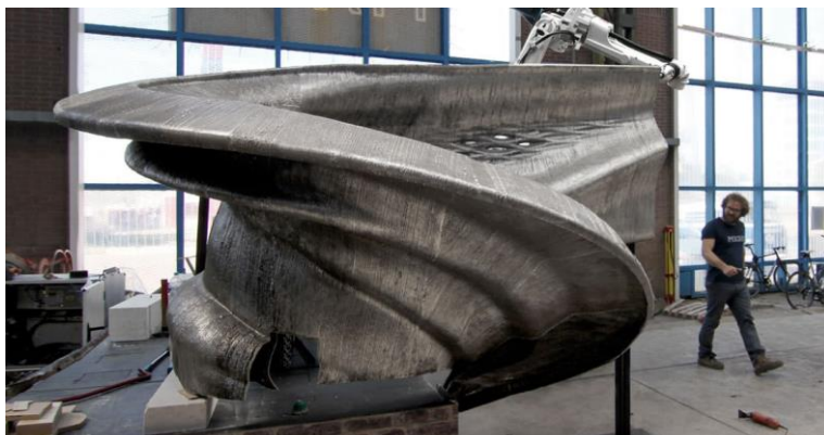
1.4pav. Pirmasis 3D spausdintuvu iš plieno spausdintas tiltas gamybos procese (Dezeen, 2018)
