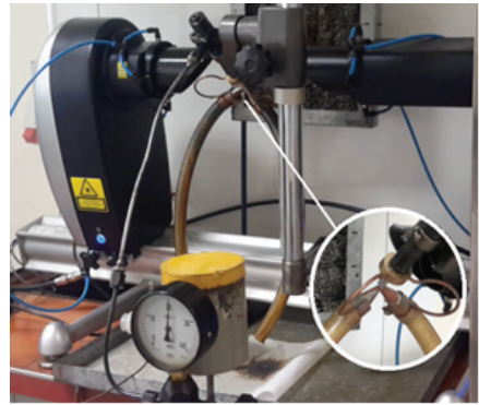
2.2 pav. Eksperimentinis stendas su kuro srautų gaudyklėmis
