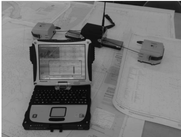
2.2 pav. Ypač tiksli navigacinė įranga „E-Sea Fix“, kurios tikslumas RTK režimu – \pm 2-5 cm
