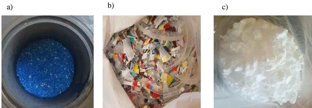
6 pav. Plastiko atliekos a) HDPE, b) PP, c) PS
