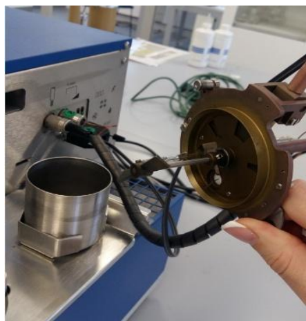
16 pav. Tyrimų dangtelio, kuriame įtaisytas mėginio termometras, degiklis, pliūpsnio temperatūros detektorius bei maišiklis, bendras vaizdas.
