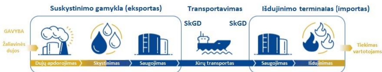
3 pav. SkGD tiekimo grandinės schema (GIIGNL, 2019)
