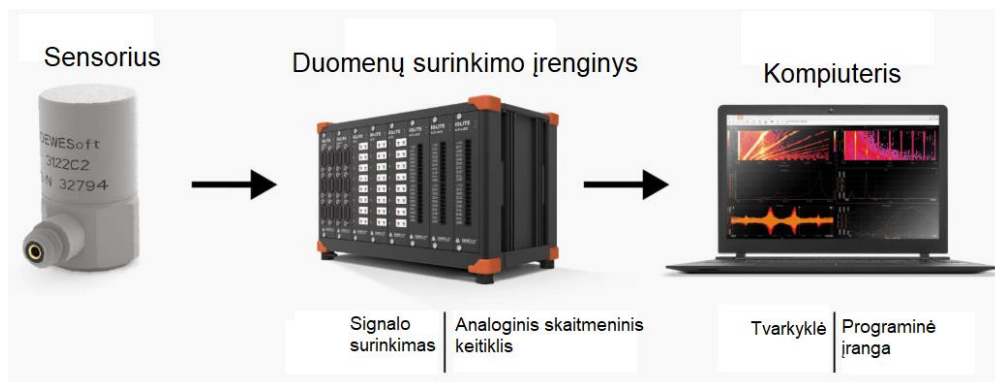
6 pav. Tipinė duomenų surinkimo sistemos sandara
