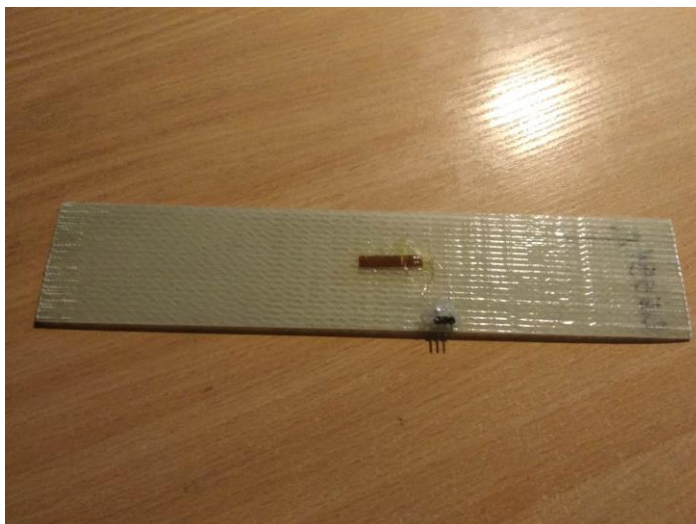
31 pav. Kompozitinio kėbulo testavimo bandinys
