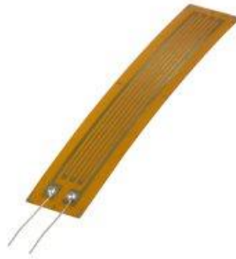
15 pav. Naudojamo įtempių jutiklio struktūra
