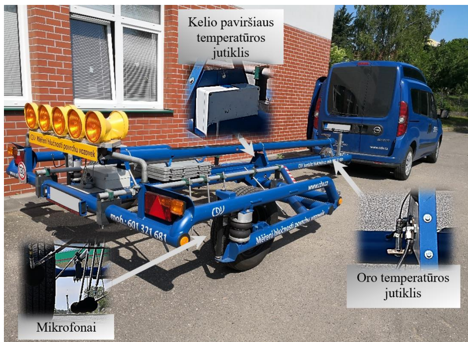
3.3 pav. Matavimo prietaisas, skirtas transporto priemonės ratų ir kelio dangos sąveikos triukšmui tirti CPX metodu
