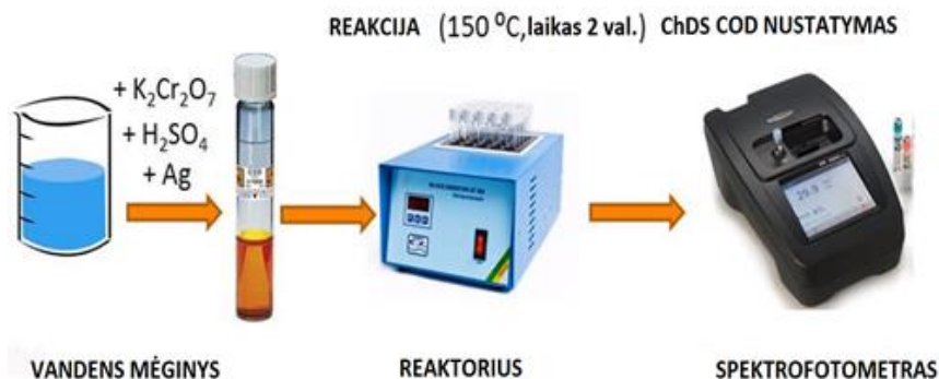
2 pav. ChDS vertės nustatymo naudojant spektrofotometrą proceso principinė schema
