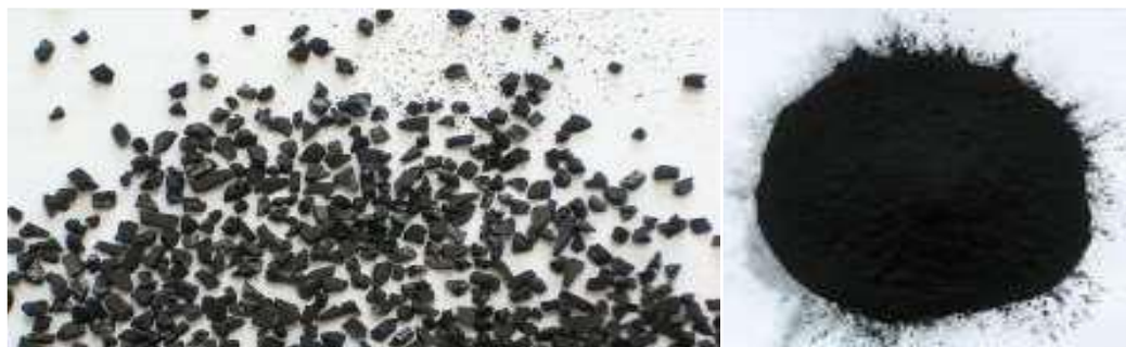
8 pav. Granuliuotos (kairėje) ir miltelių pavidalo (dešinėje) aktyvintosios anglies vaizdas (Activated Carbon Aces Environmental Solutions, 2016)
