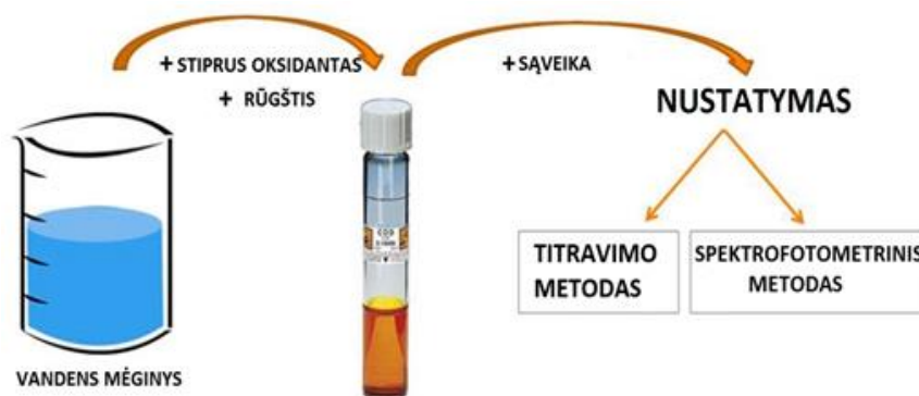
1 pav. ChDS vertės nustatymo proceso principinė schema
