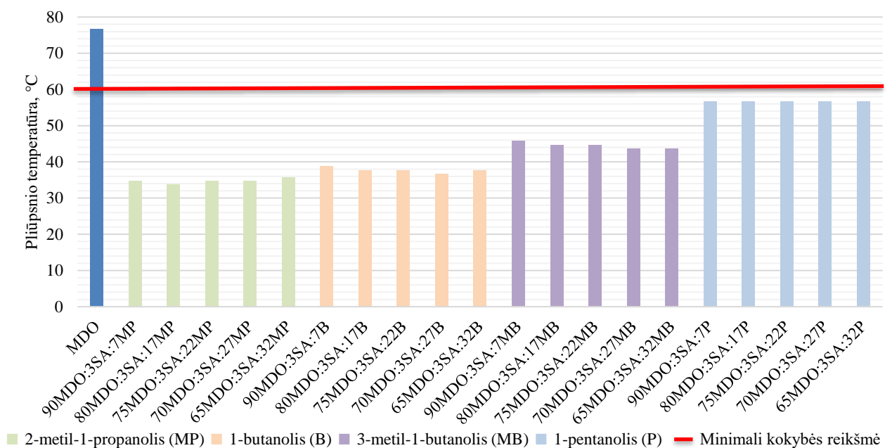
11 pav. Sukomponuotų mišinių (bazinis jūrinis dyzelinas + panaudotas saulėgražų aliejus + C4-C5 alkoholis) pliūpsnio temperatūros rezultatai
