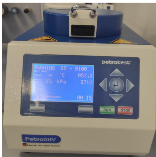
14 pav. PetroOxy – oksidacinio stabilumo nustatymo prietaisas
