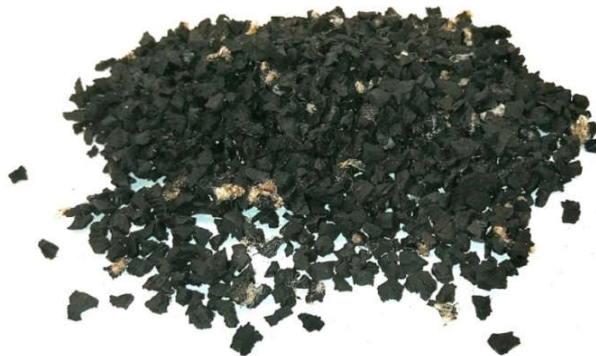
13 pav. Susmulkintos panaudotos padangos – žaliava pirolizei, matmenys 2×2×2 mm
