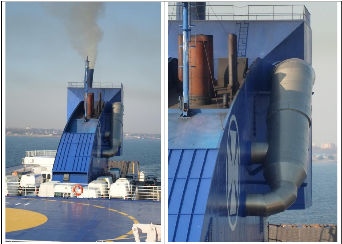
2.1.2.1 pav. Kelte „Optima Seaways“ sumontuotas skruberis. Kairėje – iš toliau, dešinėje – iš arti. Fotografuota iš 6-ojo kelto denio (asmeninio archyvo nuotraukos)
