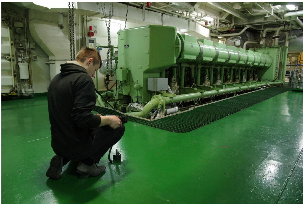
2.3.3.12 pav. Virpesių lygio matavimas antrojo denio mašinų skyriuje (21 taškas)
