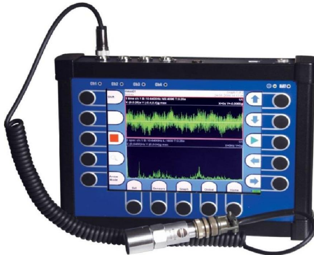
2.2.2.1 pav. ADASH A4400-VA4PRO (Čekija) virpesių signalų analizatorius [38]
