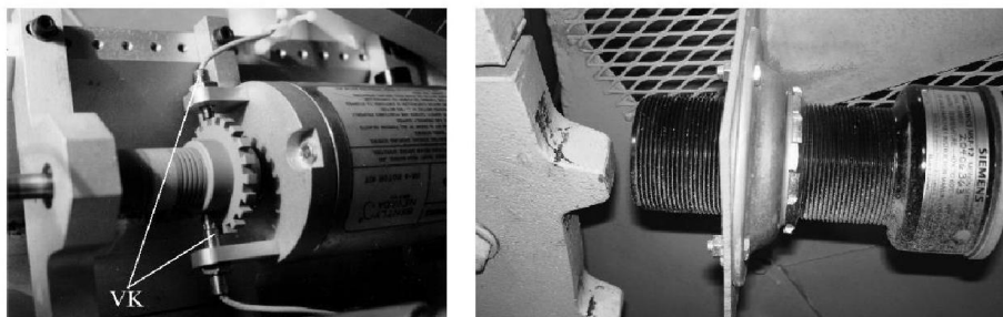
1.4.2 pav. Indukcinių bekontaktinių poslinkio matavimo jutiklių taikymas praktikoje [8]
