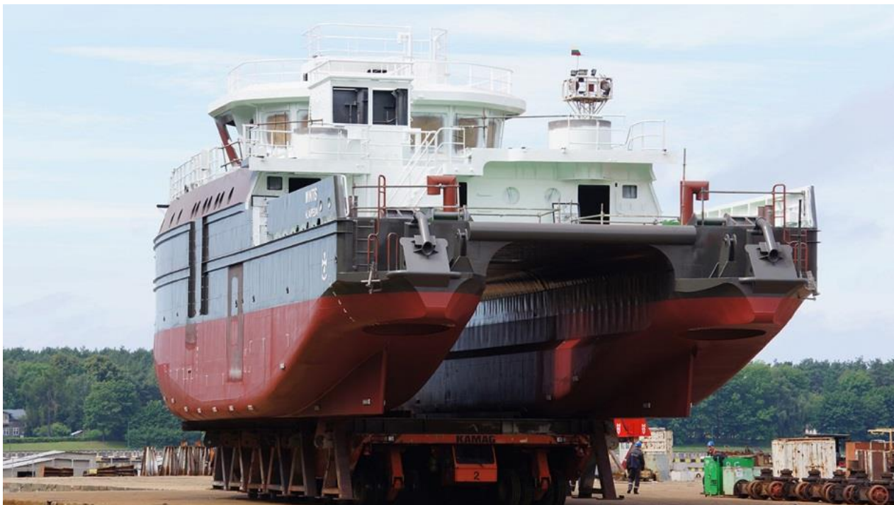
1 pav. KU mokslinių tyrimų laivo laivagalis (be varytuvų) [3]
