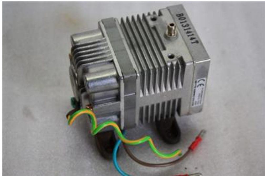
2.1 pav. Švytuojamasis variklis-kompresorius B0131414T
