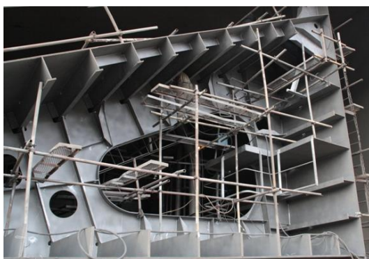
13 pav. Viso konstrukcijų bloko valymas iki Sa2,5 švarumo [46]
