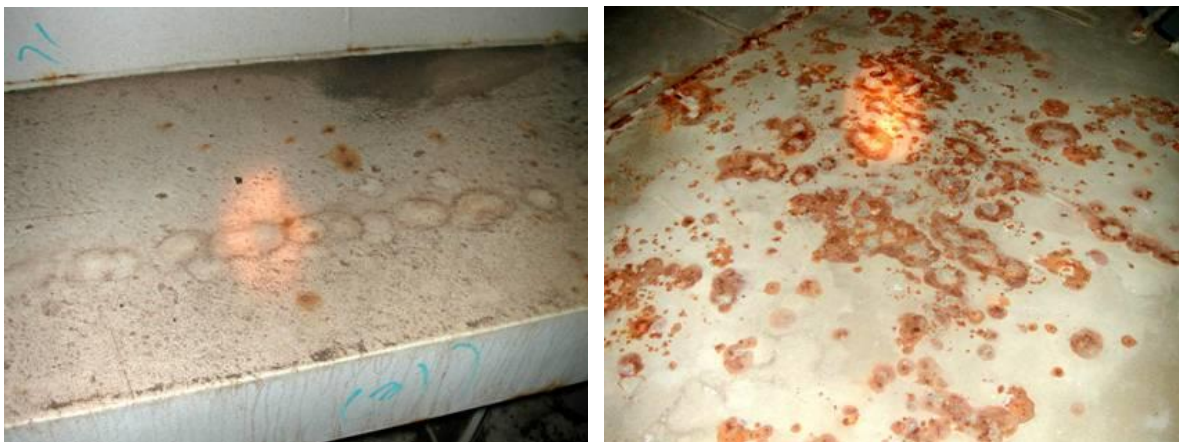
24 pav. Rūdžių dėmių augimas po dangos plėvele [37]
