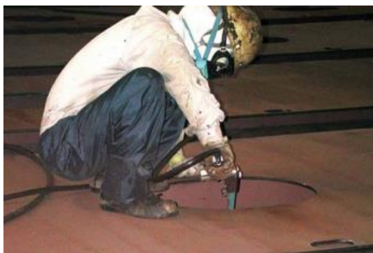
11 pav. Aštrių kraštų šlifavimas (kairėje) ir užapvalinimas (dešinėje) [3][22]
