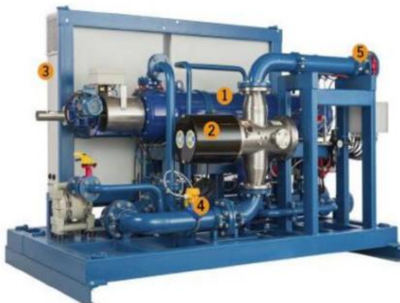
47 pav. CrystalBallast 1000 balastinio vandens valymo sistema: 1 – automatinis filtras, 2 – UV reaktoriai, 3 – valdymo skydas, 4- AFC srauto matuoklis, 5 – AFC valdymo vožtuvas [33]
