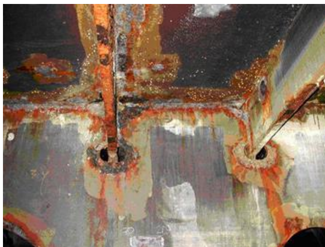
21 pav. Korozija tarp pagrindinio denio sijos ir išilginių skersinių sujungimų [4]
