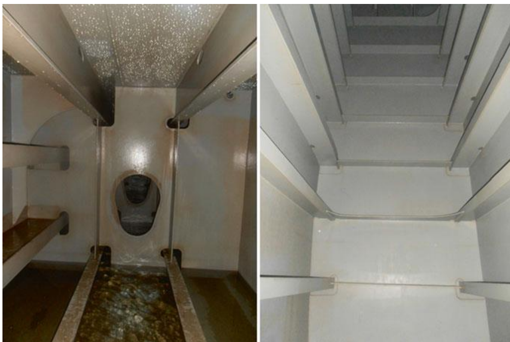
5 pav. Balastinio tanko interjeras: dvigubo dugno tankas (kairėje) ir išilginiai bortiniai tankai (dešinėje) [14]
