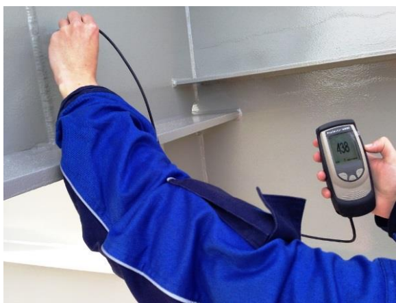
9 pav. Sausos plėvelės storio matavimas ir klasės tikrinimas [26]
