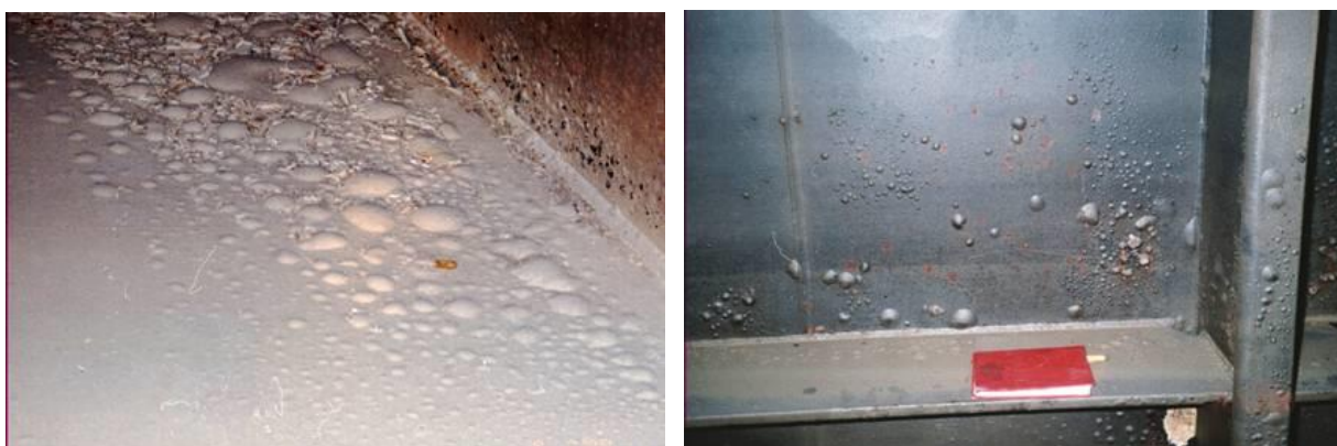
22 pav. Pūslių išsidėstymas laivo konstrukcijų dangose [37]
