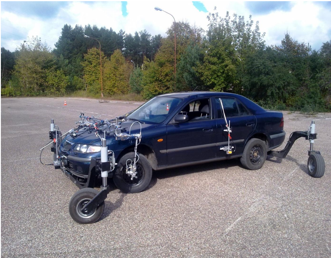
31 pav. Automobilio slydimą imituojanti sistema
