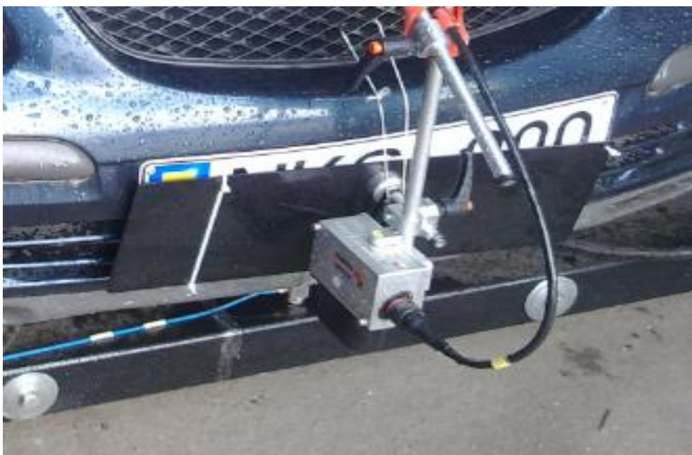
33 pav. Correvit S-350 jutiklio bendras vaizdas ant automobilio MAZDA 626
