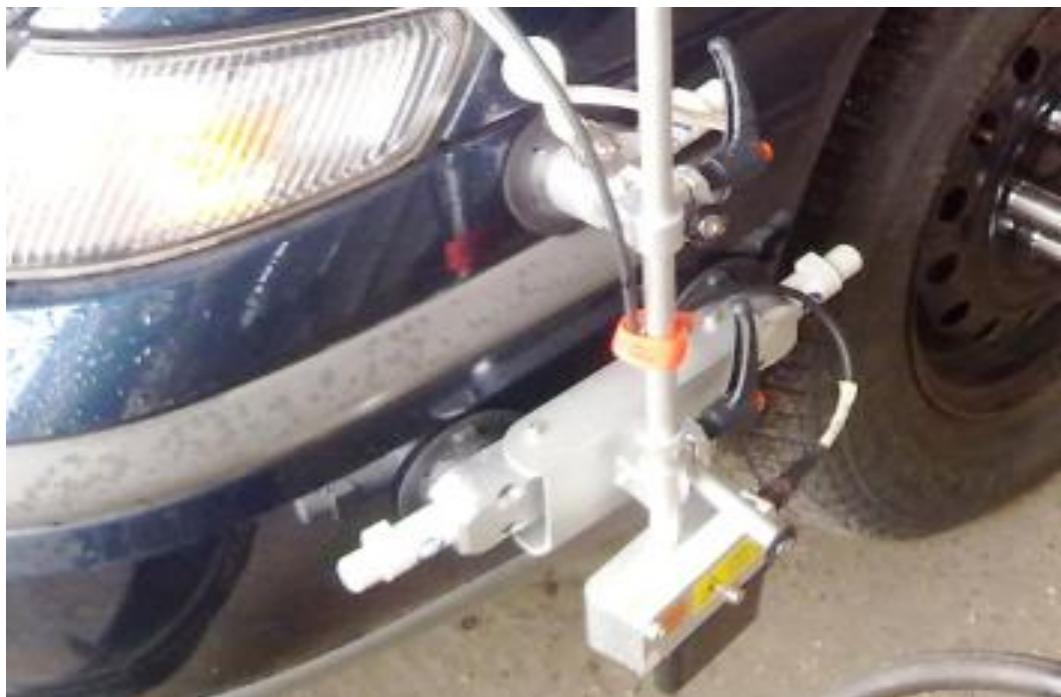
35 pav. Correvit HF-500C jutiklio bendras vaizdas ant automobilio MAZDA 626
