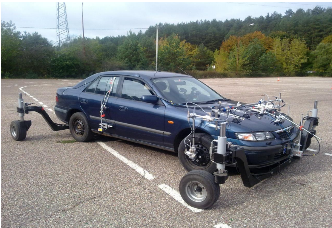
32 pav. Automobilis „Mazda 626“ su slydimą imituojančia bei matavimo įranga
